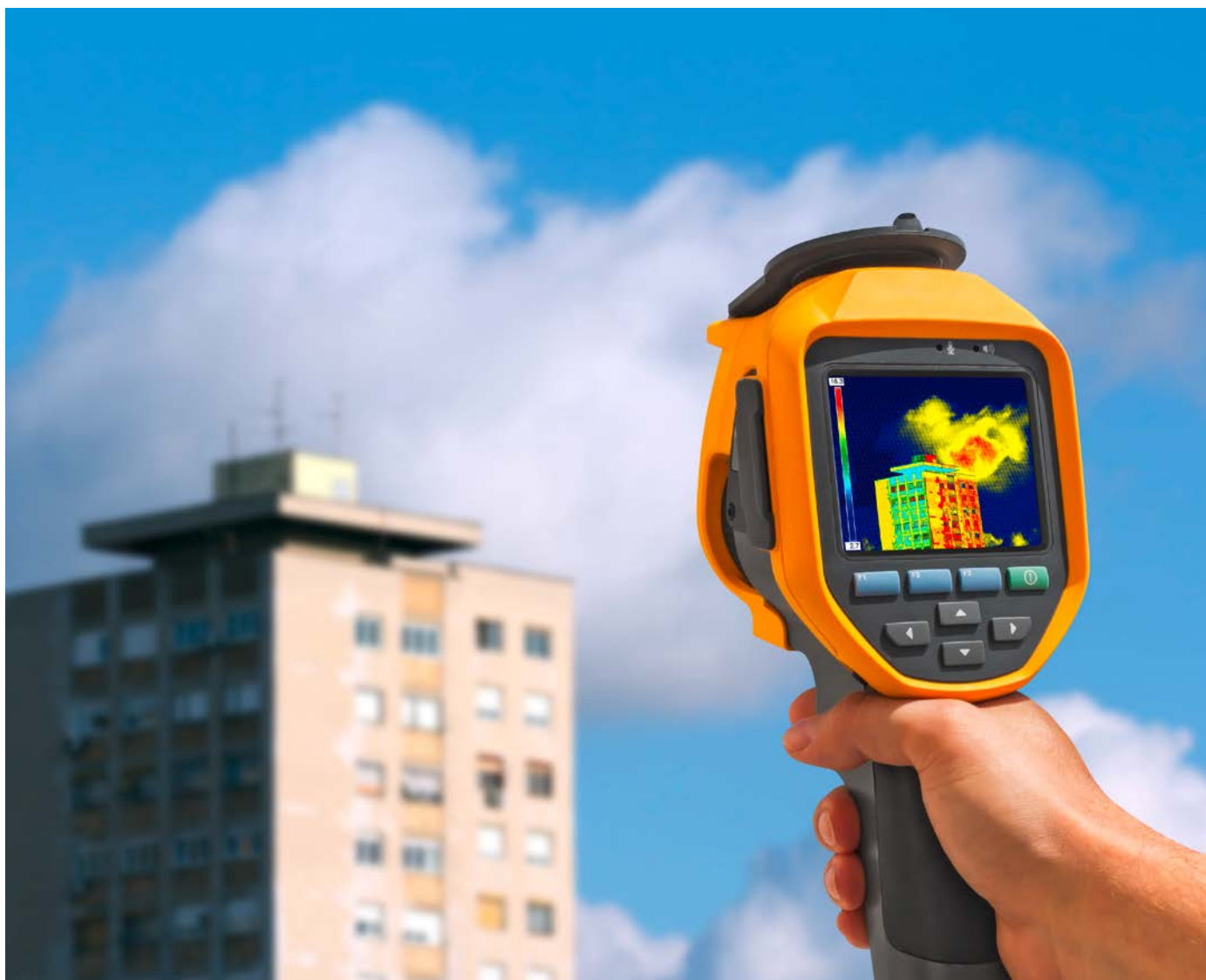
Energieeffizienzuntersuchung eines Wohngebäudes mit Wärmebildkamera
